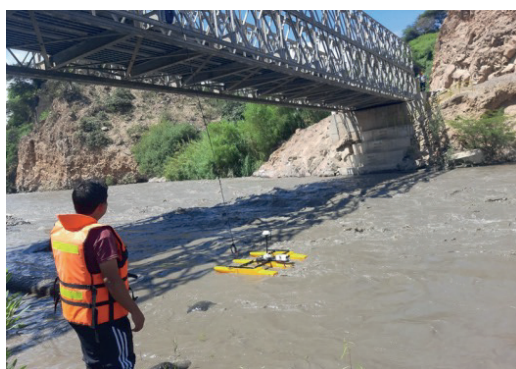
Aforo con ADCP en el río Chicama, estación El Tambo (DZ3)
