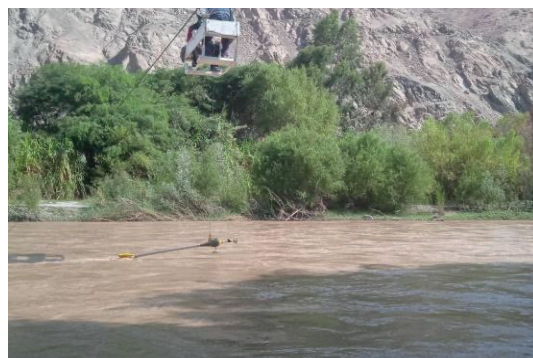
Medición de Caudal del río Majes en la Estación Hidrológica HLG Huatiapa con Correntómetro OTT-C31 (DZ13)
