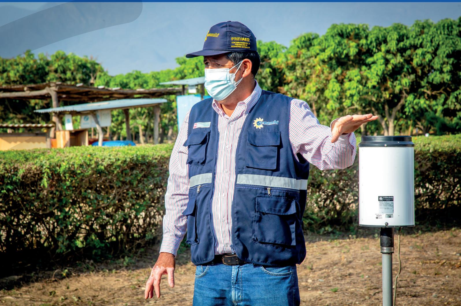
Especialista de agrometeorología de la DZ 2 muestra pluviómetro en la EMA Tongorrape, Lambayeque.
