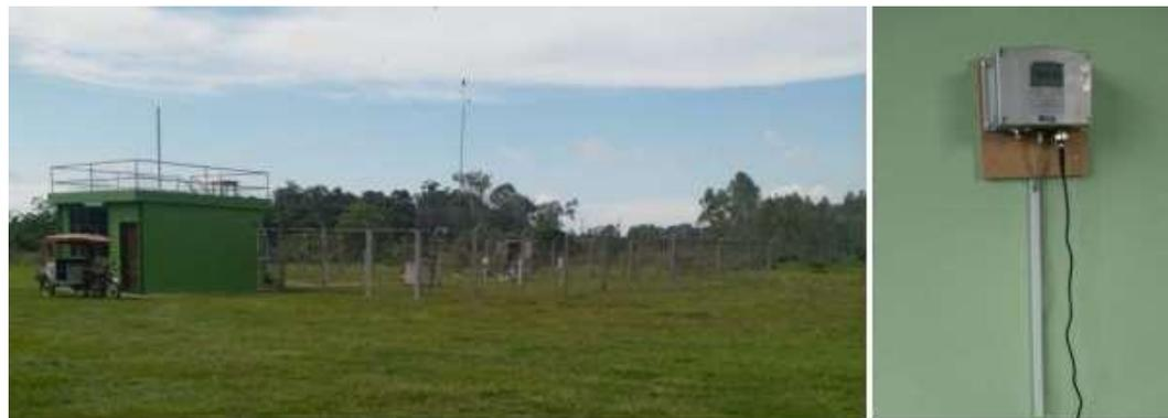
**Instalación del Barómetro digital en la Estación Climatológica principal convencional CP Pucallpa.**
