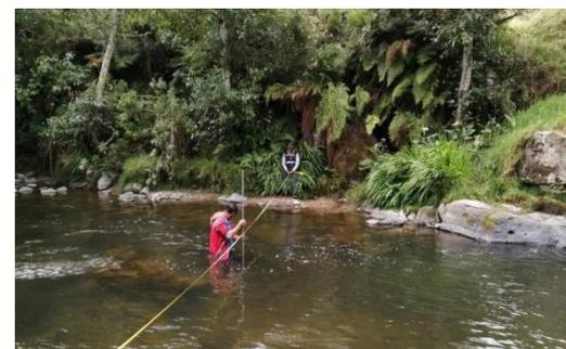
Aforo con el equipo MF Pro en la estación EHMA
