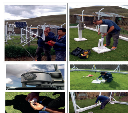
Mantenimiento de pluviómetro, sensor y pintado de cerca
