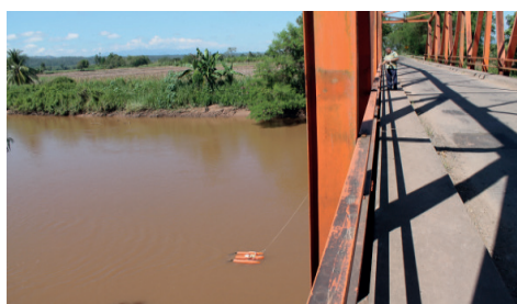
Aforo con ADCP en el río Biavo, estación del mismo nombre.
