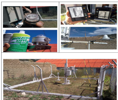
Sensor y cambio de transmisor satelital – Estación automática
