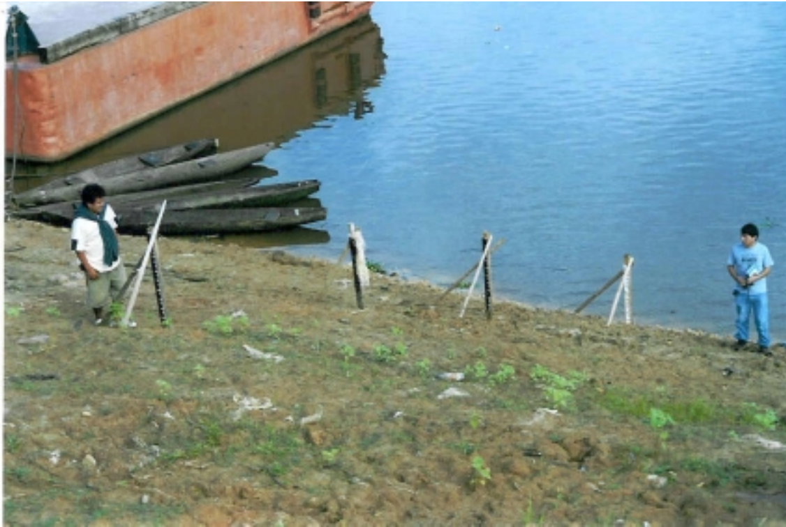
Elementos bajos de las escalas de Requena reinstaladas por el observador
