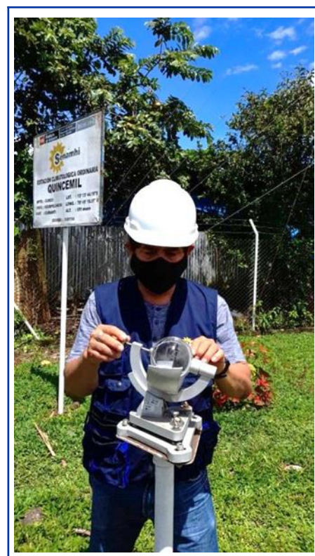
Figura 22. Registro y observación de radiación solar con el Heliógrafo
