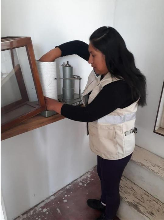
Cambio de banda del Microbarógrafo.
