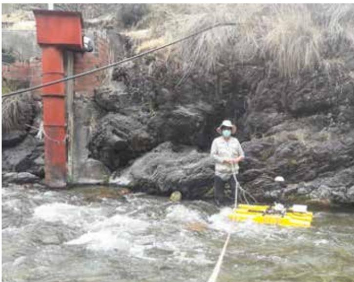
Aforo en el río Shullcas con el equipo ADCP, este río tiene alrededor de 1 m<sup>3</sup>/s de caudal durante esta temporada. También puede ser practicado con vadeo por correntómetro.
