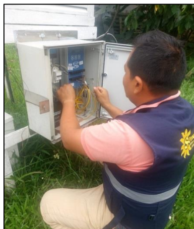
Foto 11: Estación meteorológica automática Amazonas/Registrador de datos/Sutron/9210/1506172
