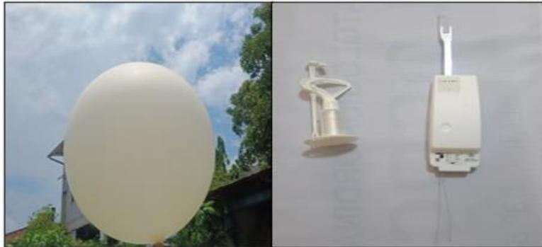
Fotos 10 y 11. Globo látex y dispositivo de radiosonda
