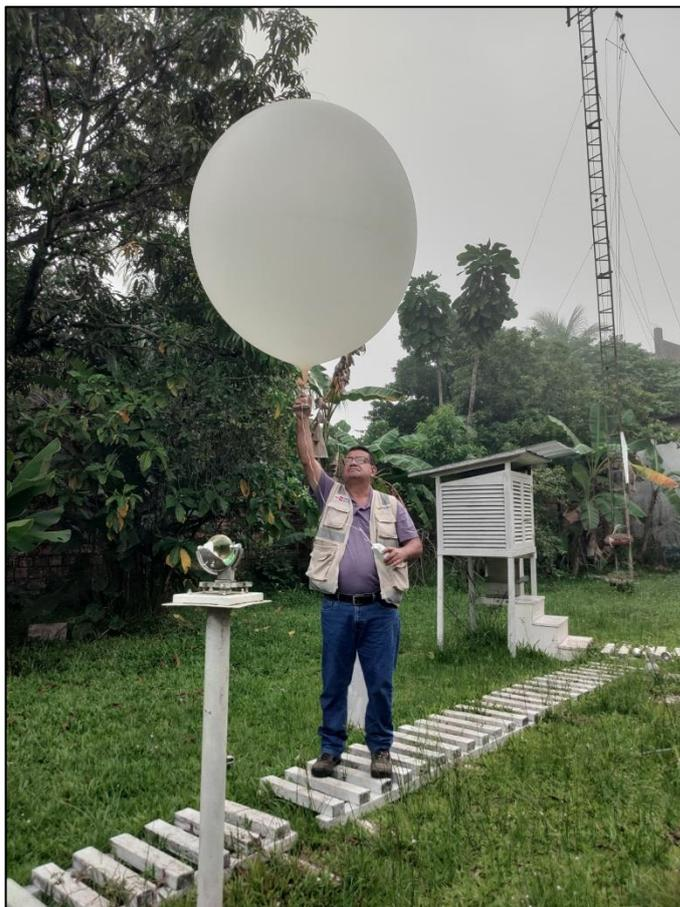
El SENAMHI viene realizando el lanzamiento de radiosondas meteorológicas (RWS) mediante globos meteorológicos, con el propósito de monitorear y analizar el perfil atmosférico en la ciudad de Iquitos, contribuyendo a una mejor comprensión de las condiciones climáticas y a la mejora de los pronósticos locales.
