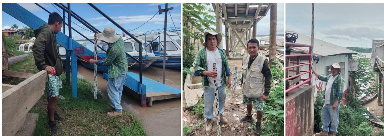
Especialistas realizaron la nivelación de la estación HLM-Nauta.
