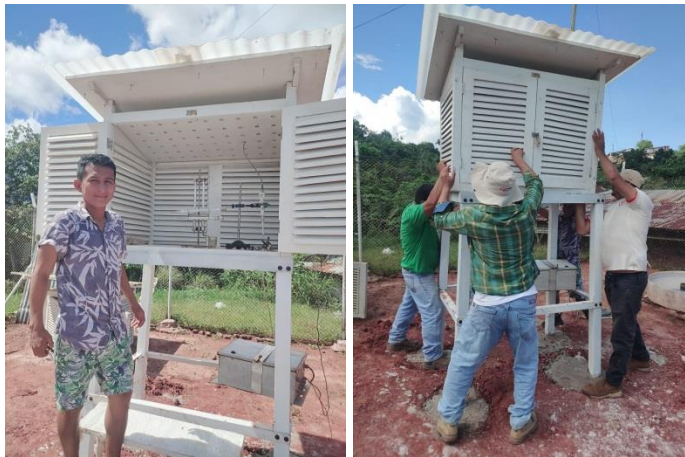
Especialistas instalaron nueva caseta meteorológica en la estación Climatológica Ordinaria "Nauta".
