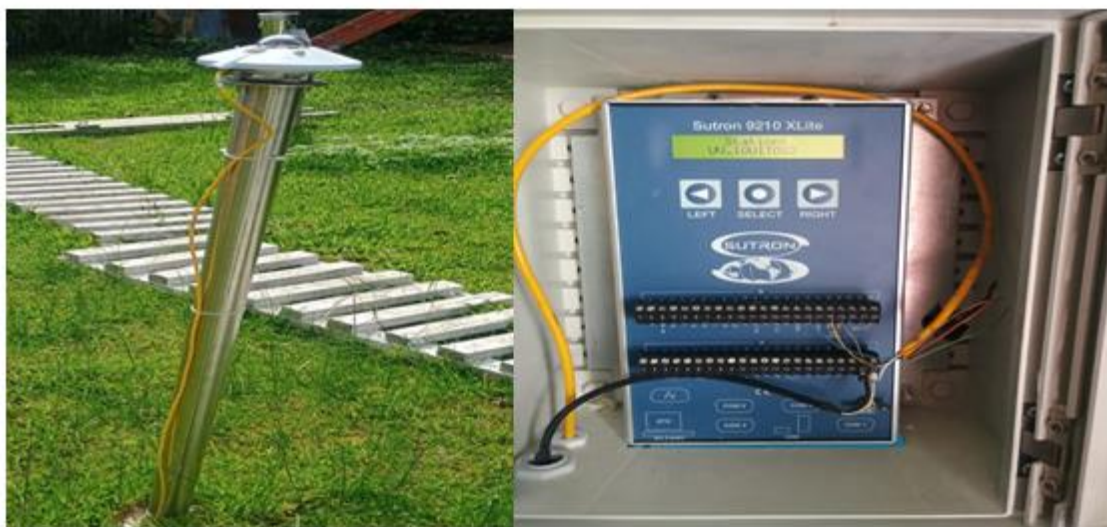
Fotos 9 y 10: Estación Climatológica Ordinaria Amazonas – Radiómetro. Instrumento de medición de alta calidad UV. Utilizada para medir la energía ultravioleta de la fuente solar.
