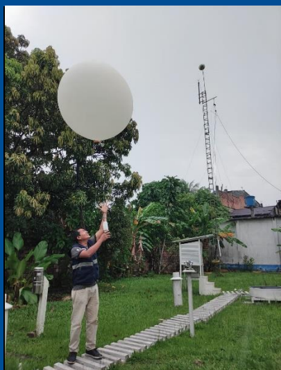
Lanzamiento de Radiosonda – RWS, Estación Iquitos-Morona.
