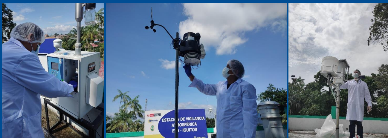
Mantenimiento de las estaciones automáticas Davis.
