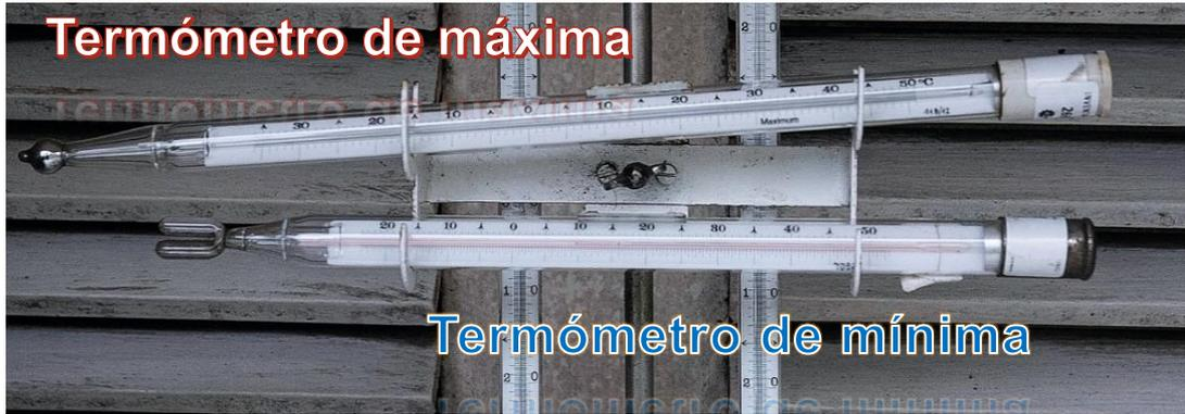
**Fig. 1** Termómetros de la temperatura máxima y mínima en una caseta meteorológica
