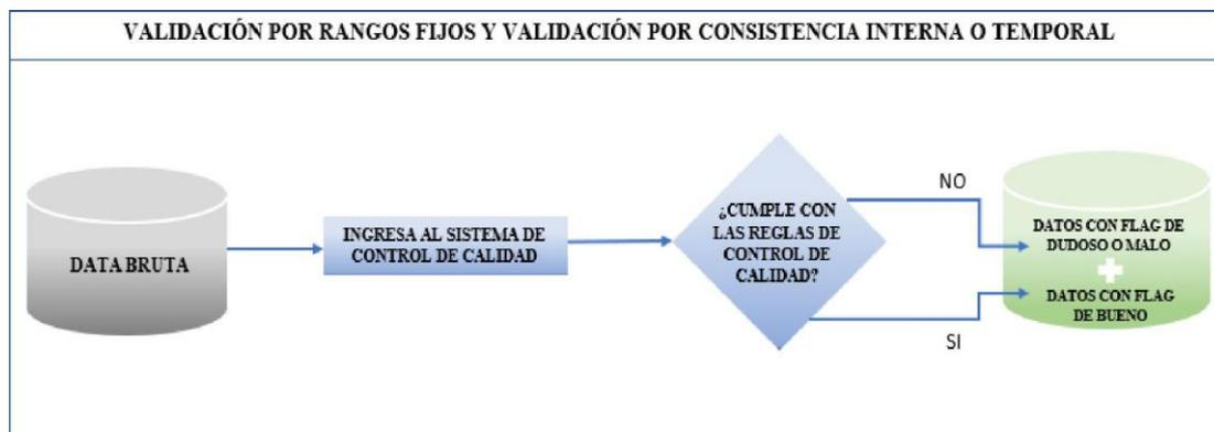
Figura 6.1: Secuencia de la fase automática del proceso de control de calidad de datos y los datos resultantes con el banderín correspondiente
