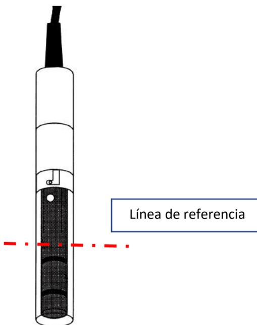
**Figura 11.** Línea de referencia para sumergir el conductímetro
