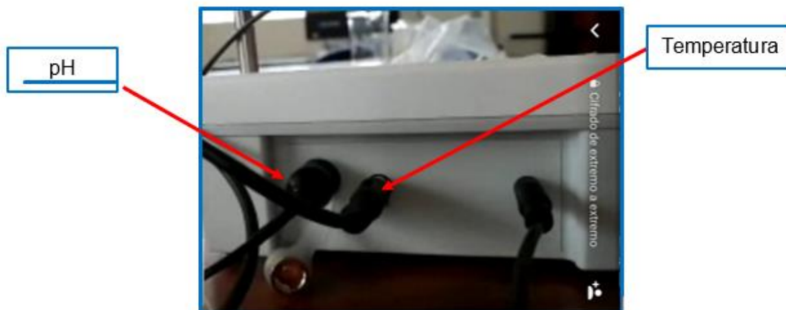
Figura N° 13. Conexión de los electrodos de pH y temperatura
