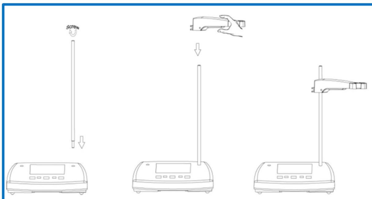
**Figura 12.** Instalación de brazo integrado
