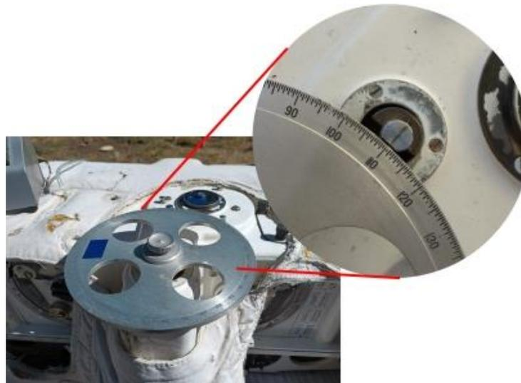
**Figura 19. Disco dial del espectrofotómetro**
