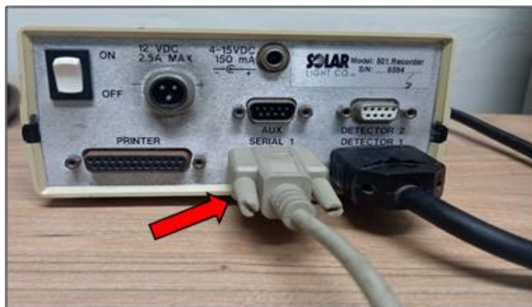
Figura N°7 – Conexión del cable de transferencia de datos al registrador
