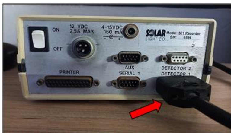
Figura N°6 – Conexión del cable que proviene del radiómetro al registrador
