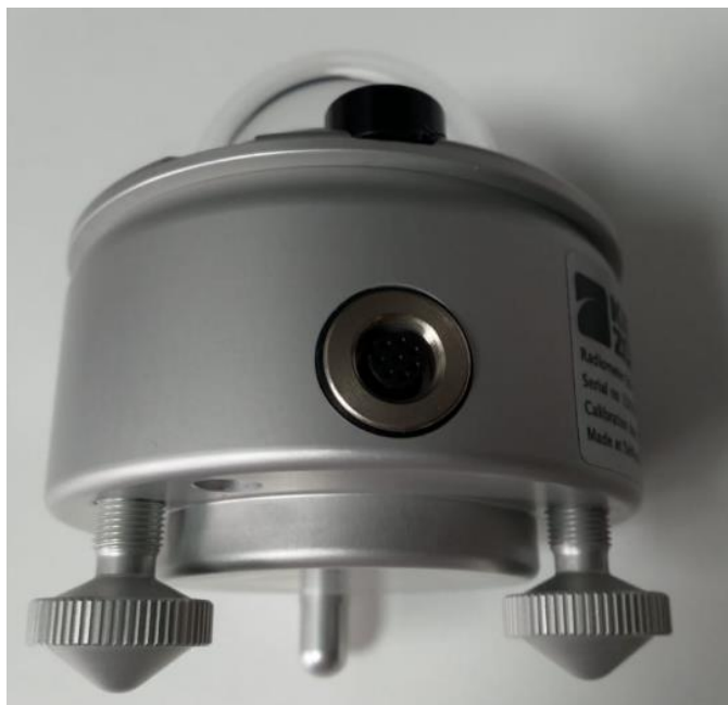
Figura N°04: Patas niveladoras del sensor
