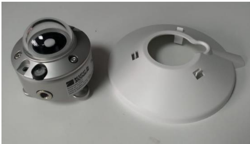
Figura N°03: Pantalla solar desmontada
