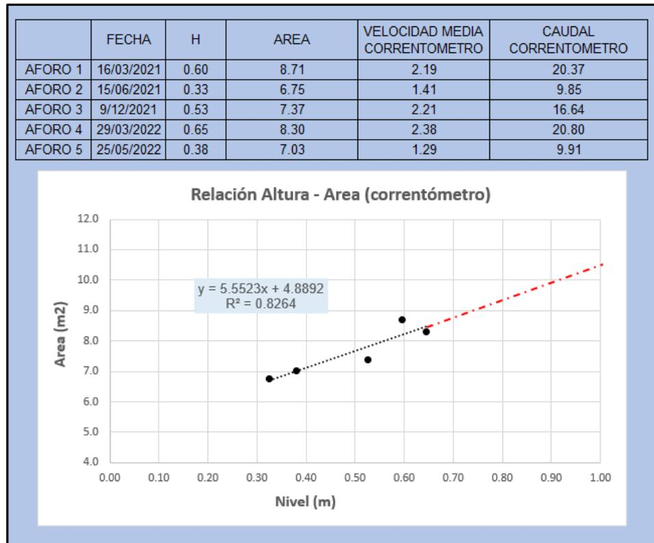
**Estimación de caudal: (Método Correntómetro)**
