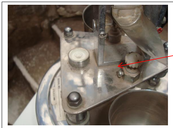
Figuras N° 27 Componentes interiores de sensores de precipitación sucios - 8
