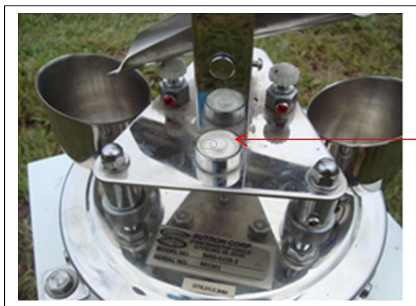
Figura N° 28 Sensor de precipitación desnivelado – 9
