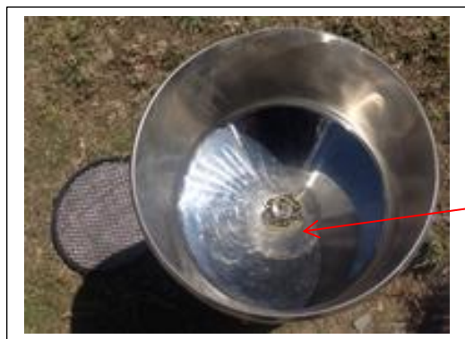
Figuras N° 20 Malla tubular y orificio de entrada con residuos – 2
