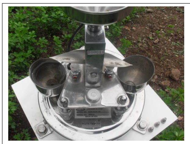
Figura N° 25 Cubeta basculante con polvo – 6
