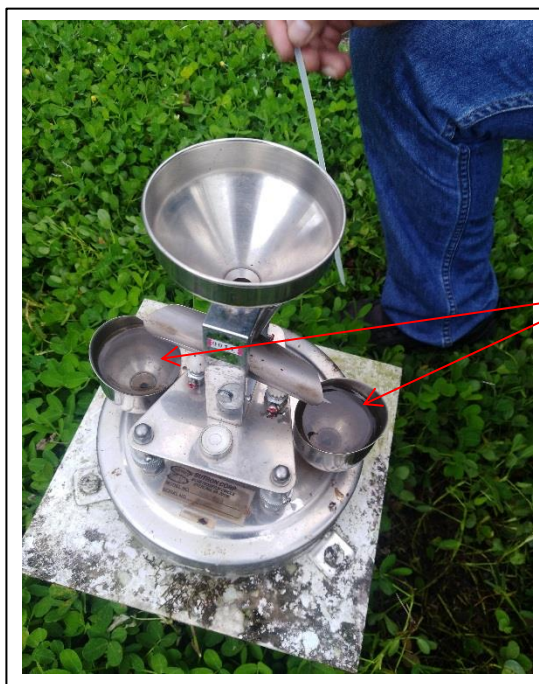
Figura 32 Sensor con cubetas de desfogue obstruidas
