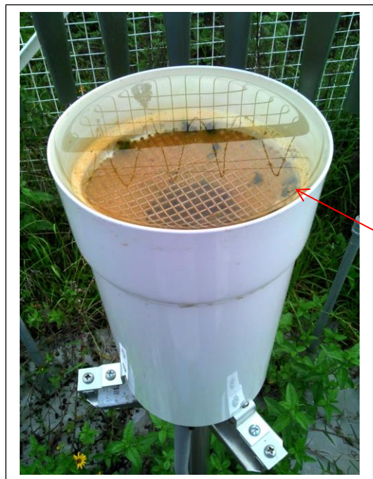
Figura N° 18 y 19 Sensores con agua empozada en la carcasa exterior - 1
