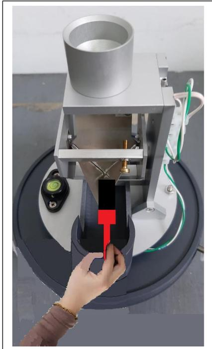
Figura N° 08 Limpieza de cubeta basculante
