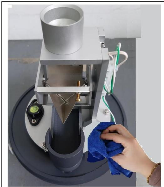
Figura N° 09 Limpieza de la parte interna del sensor de precipitación
