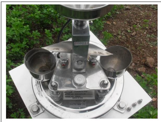
Figura N° 20 Cubeta basculante con polvo – 6
