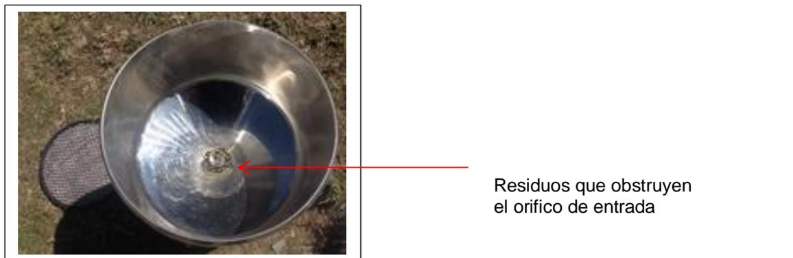
Figuras N° 15 Orificio de entrada con residuos – 2
