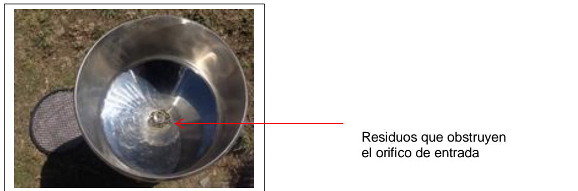
Figuras N° 19 Orificio de entrada con residuos – 2
