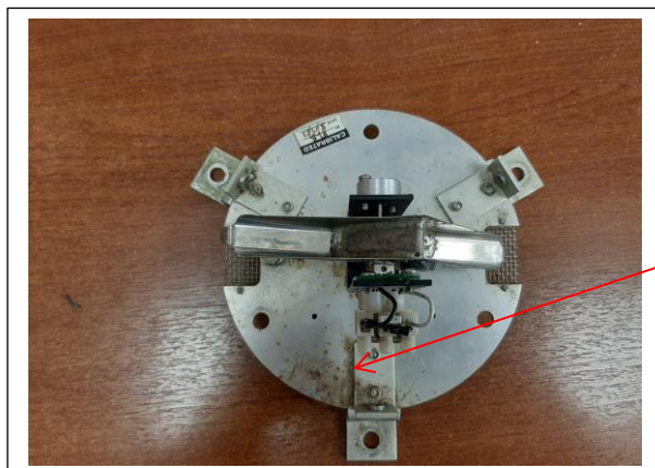
Figuras N° 25 Componentes interiores de sensores de precipitación sucios - 7
