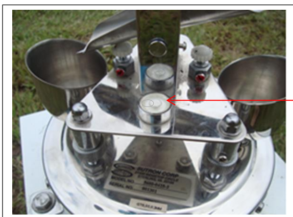
Figura N° 26 Sensor de precipitación desnivelado – 8
