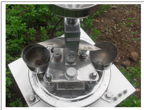
Figura N° 24 Cubeta basculante con polvo – 6
