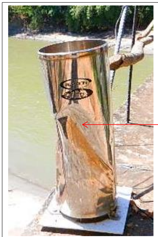
Fig. 28 Sensor con deformación - 10
