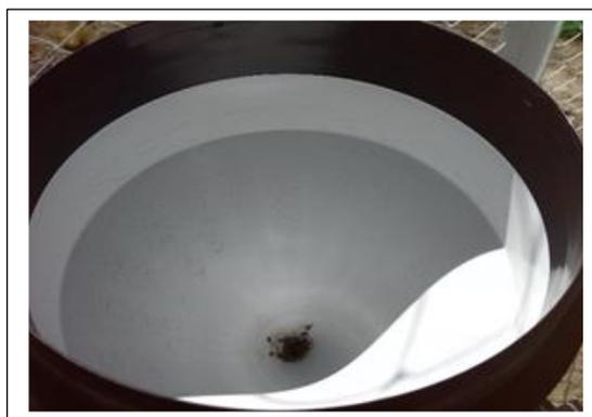
Figuras N° 24 y 25 Orificio de carcasa metálica obstruida – 2
