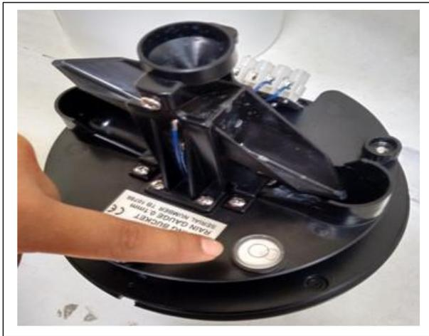
Figura N° 34 Sensor de precipitación desnivelado – 9
