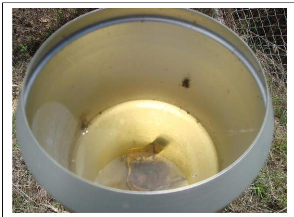
Figuras N° 22, y 23 Sensores con agua empozada en la carcasa exterior del sensor – 1
