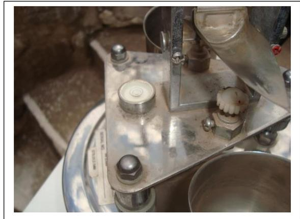
Figuras N° 32 y 33 Componentes interiores de sensores de precipitación sucios - 8
