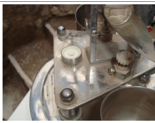
Figuras N° 29 y 30 Componentes interiores de sensores de precipitación sucios - 8
