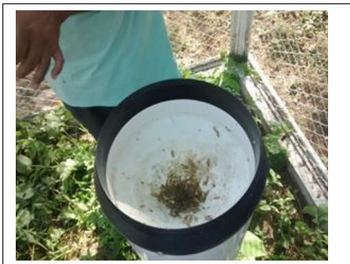
Figuras N° 21 y 22 Orificio de carcasa metálica obstruida – 2
