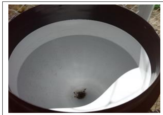
Figuras N° 21 y 22 Orificio de carcasa metálica obstruida – 2
