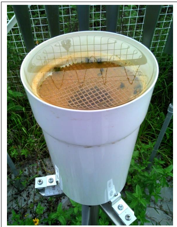
Figuras N° 18, 19 y 20 Sensores con agua empozada en la carcasa exterior del sensor – 1
