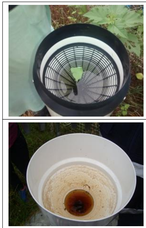
Figuras N° 18, 19 y 20 Sensores con agua empozada en la carcasa exterior del sensor – 1
