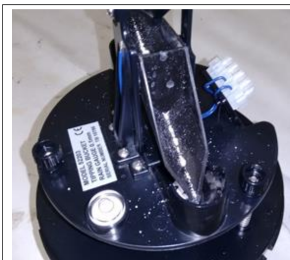
Figura N° 27 Cubeta basculante con polvo – 6
