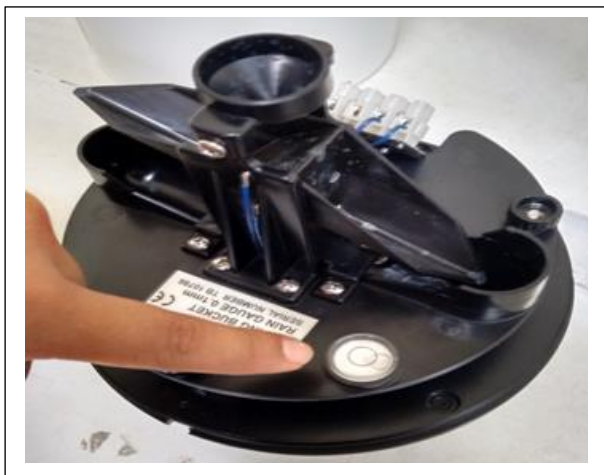
Figura N° 31 Sensor de precipitación desnivelado – 9
