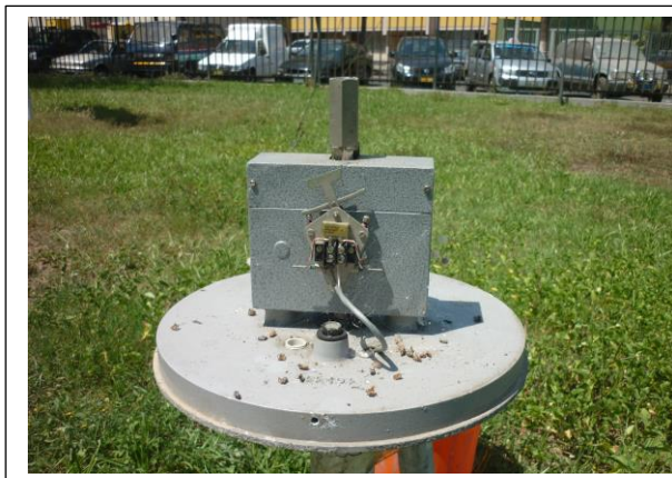
Figuras N° 29 y 30 Componentes interiores de sensores de precipitación sucios - 8
