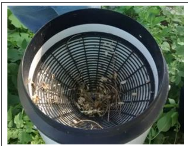
Figura N° 25 Malla de plástico sucio con polvo u objetos (hojas, ramas, piedras, residuos orgánicos impregnados) – 4
