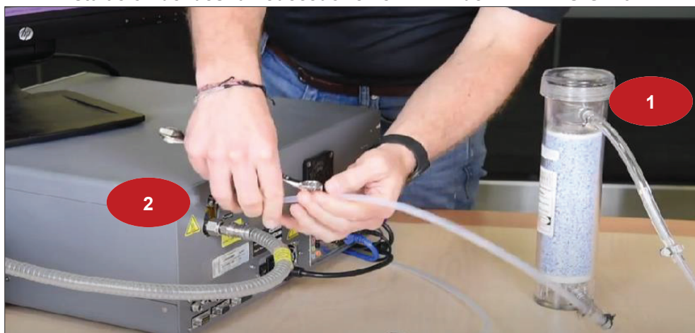
Figura 9 Instalación del deshumecedor en el INLET del PICARRO G2401
