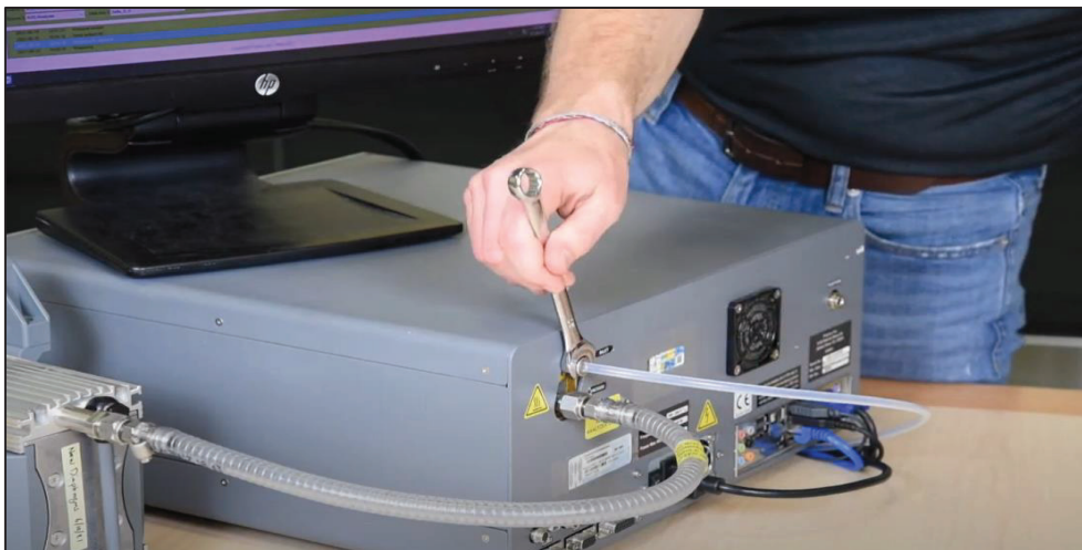
Figura 2 Colocación y ajuste de la manguera principal de ingreso de aire al equipo PICARRO G2401
