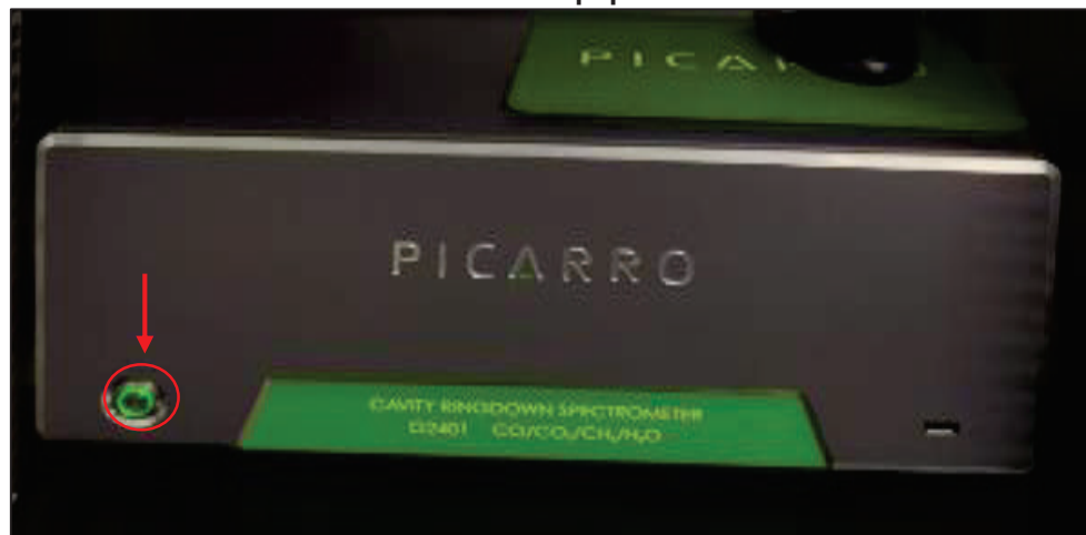
Figura 5 Botón de encendido del equipo PICARRO G2401
