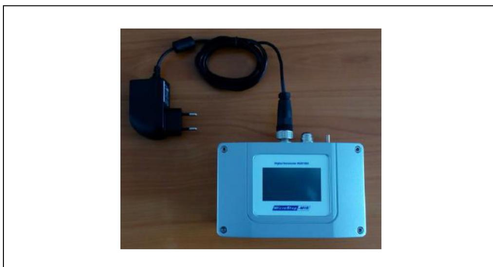
El nivel de carga al 100% debería completarse en 3 horas aproximadamente, y a temperatura ambiente dentro del rango de 0 °C a 50 °C, de lo contrario no cargará. La batería debe estar lo suficientemente cargada para alimentar el barómetro durante la conexión de la computadora.
