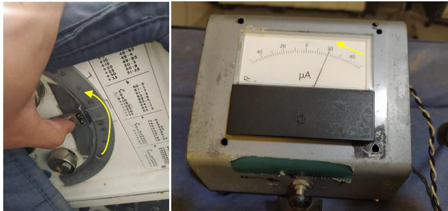
**Figura 22:** Suba la palanca Q1, viendo que el micro amperímetro retroceda hasta 20  $\mu\text{A}$ .
