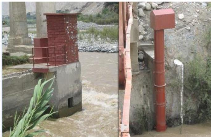
**Figura 5.3** Casetas limnigráficas, de toma directa. A la izquierda, Estación Socsi - río Cañete; a la derecha Estación Antapucro - río Lurín
