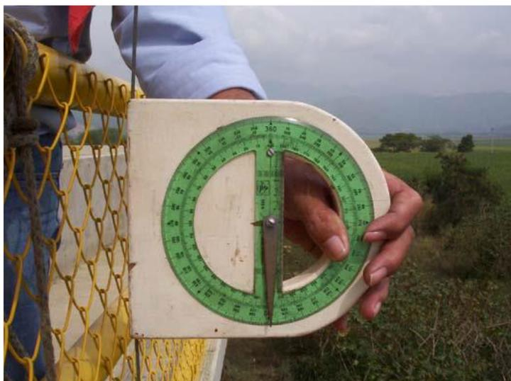
**Figura 5.40** Transportador para medir ángulo de arrastre
