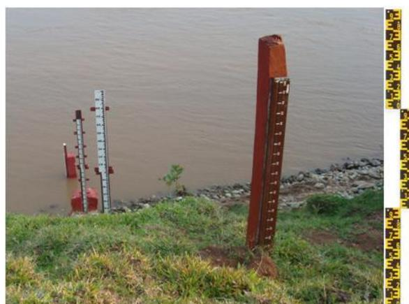
**Figura 5.2** Reglas limnimétricas instaladas en cursos de agua
