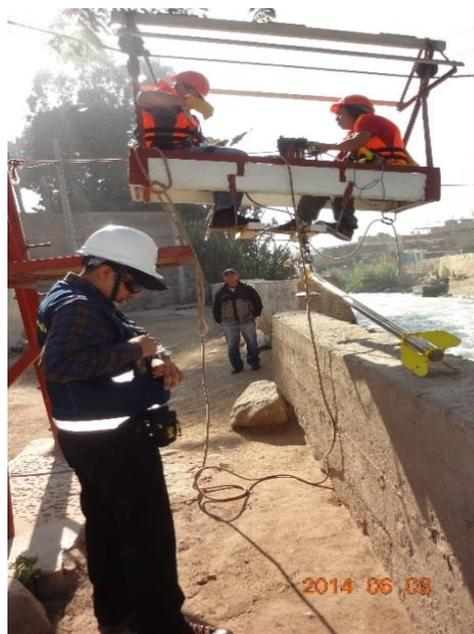
**Figura 5.12** Preparación para el aforo desde carro huario en la Estación de Chosica-Río Rímac-Lima
