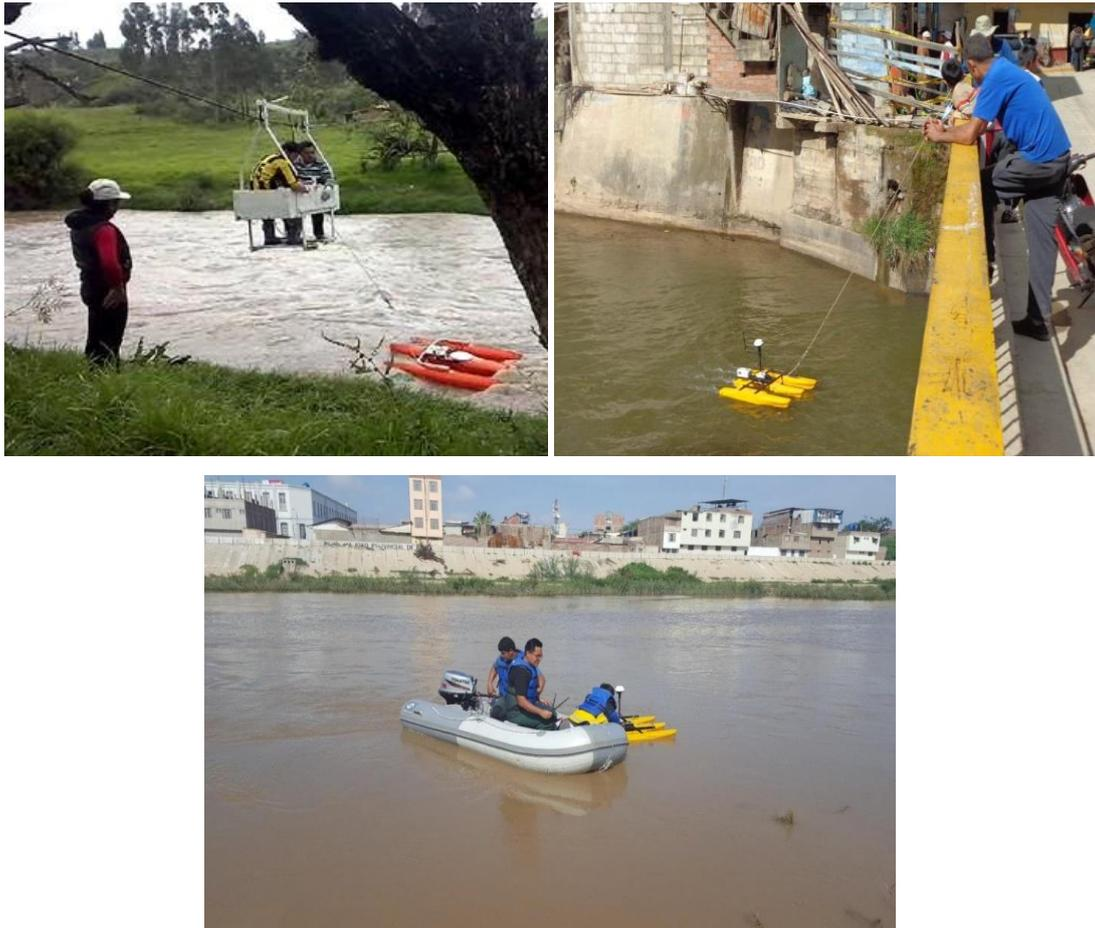
**Figura 5.16** a) Aforo desde carro huaro con ADCP RiverRay. b) Aforo desde puente con ADCP M-9 c) Aforo con ADCP M-9 desde embarcación con motor fuera de borda
