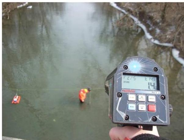
**Figura 5.21** Calibración de la pistola mediante mediciones comparativas con ADCP
