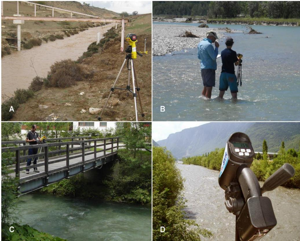
**Figura 5.20** Vista de diferentes formas de utilizar la pistola radar en cursos naturales
