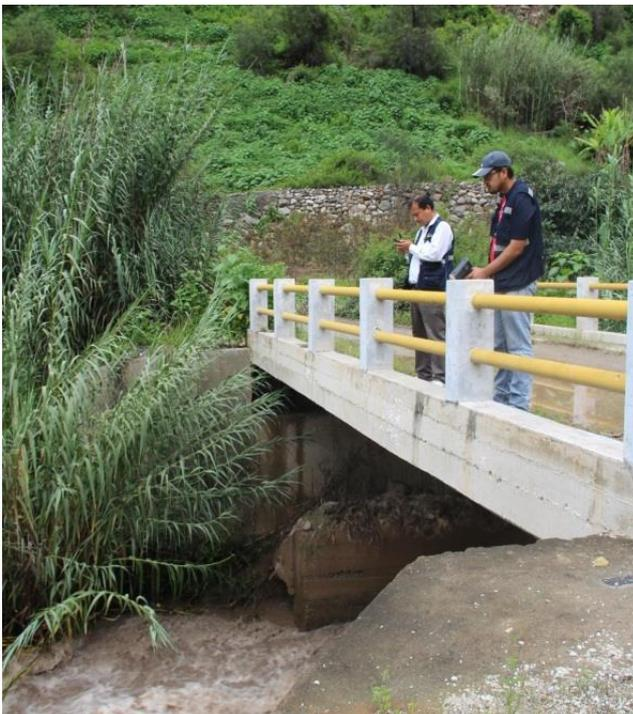
**Figura 5.23** Aforo del río Chancay-Huaral en Pte. Cuchuanca, con pistola radar SVR
