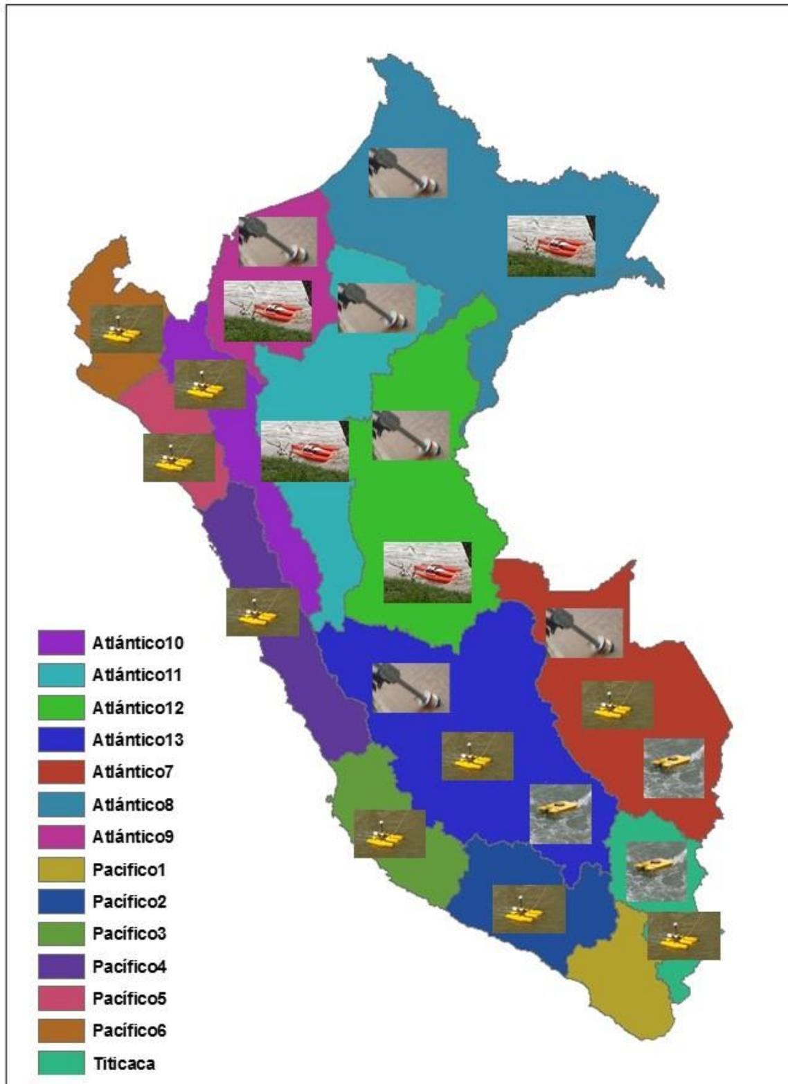
**Figura 5.18** Regiones hidrológicas del Perú donde el SENAMHI realiza aforos con diferentes equipos ADCP
