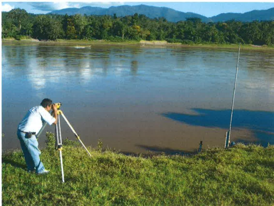
Trabajos de monumentación de puntos geodésicos y nivelación del cero de la escala limnimétrica
