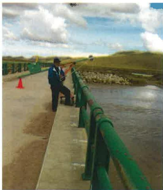
Para el aforo por suspensión desde puentes, adicionalmente al equipamiento indicado en el párrafo anterior, es conveniente utilizar una estructura (tipo grúa) portátil y robusta provista de un mecanismo de poleas que permita sumergir el correntómetro y lastre al río, como se ilustra en la Figura 5.13.
