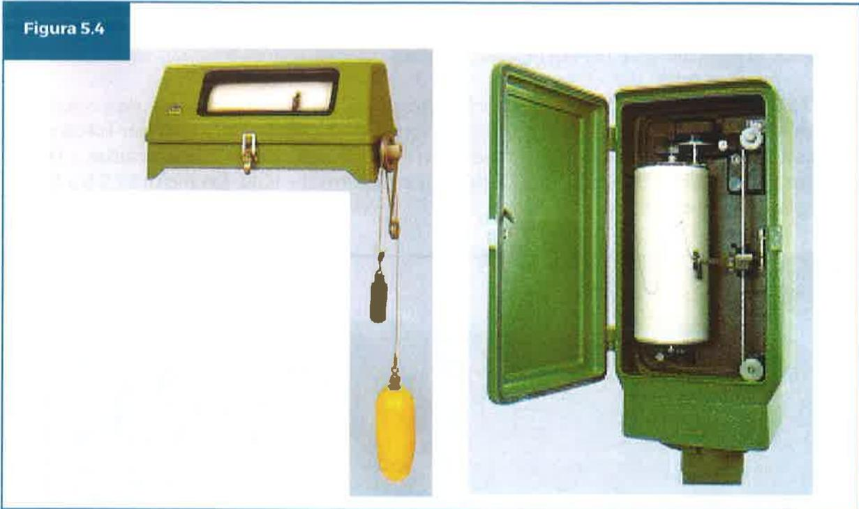
Equipos limnigráficos de eje horizontal y vertical
