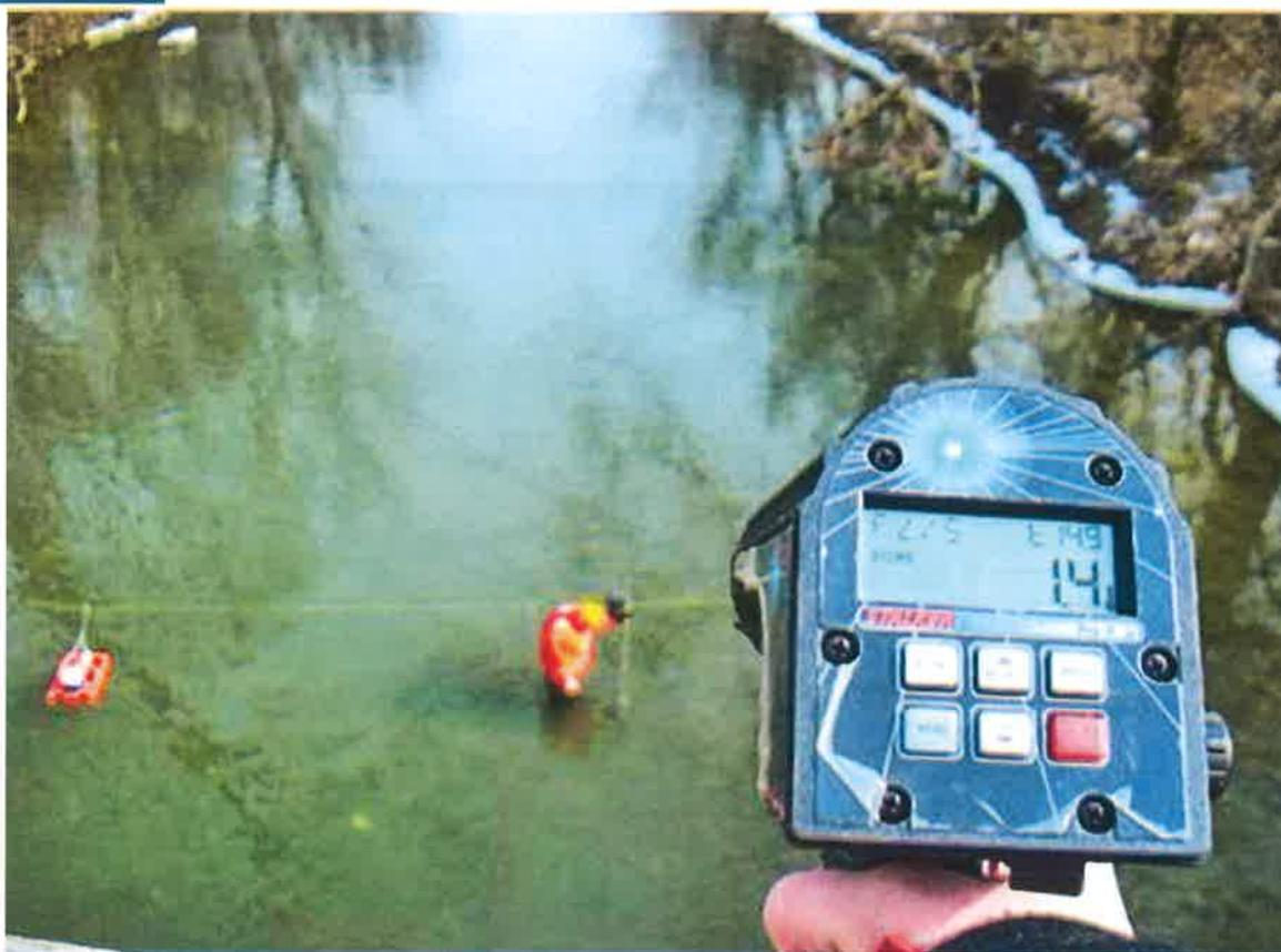
Calibración de la pistola mediante mediciones comparativas con ADCP
